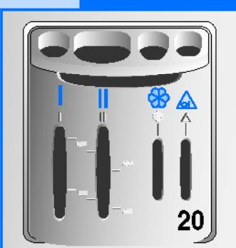
**Прим.** При заполнении отделения моющим средством важно, чтобы он не попал в отделение кондиционера, иначе при полоскании образуется пена, а на вещах могут остаться белые пятна. И, наоборот, в случае попадания кондиционера в отделение моющего средства он снижает эффективность последнего.
