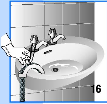
▼ Если вода из машины должна выливаться в раковину или мойку, повесить свободную оконечность сливного шланга, изгиб которой зафиксирован специальным входящим в комплект держателем, на край мойки и закрепить держатель так, чтобы он не упал на пол (рис. 16). Слив мойки не должен быть засорен и вода должна стекать быстро, чтобы избежать перелива.
