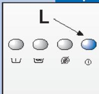
Выбрав нужную программу стирки, нажмите эту кнопку, и стиральная машина начнет цикл стирки. При этом загорается кнопка (L), указывая на начало цикла стирки. По завершении цикла стирки кнопка (L) мигает, теперь можно открыть дверь и вынуть из машины белье.
