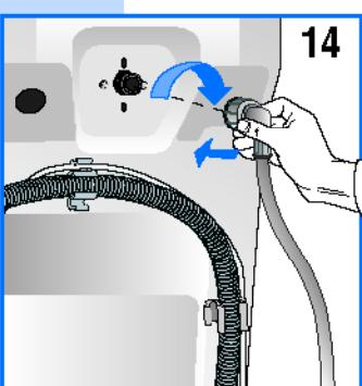
**Прим. Использовать новую прилагаемую в комплекте к машине трубку и не использовать старую.**
